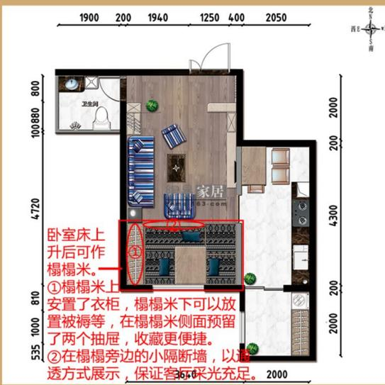
此案例设计了可升降分体吊床和榻榻米，白天作招待茶室，吊床分两体摇动吊空，不会给下方带来视觉上的压迫感；晚上再将床摇下来睡觉休息。设计新思路使54m<sup>2</sup>小户型也能舒适得体！
